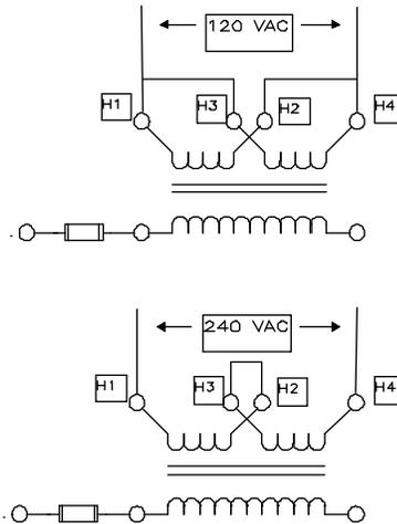
NOTE: TRANSFORMER JUMPERS MUST BE CONFIGURED FOR CORRECT INPUT (PRIMARY) VOLTAGE
