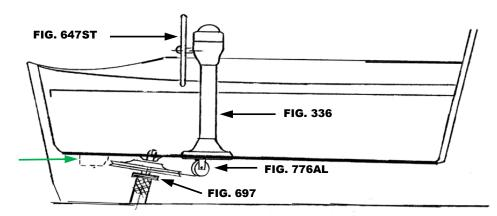
MEASURE CLEARANCE OF BILGE PUMP CAREFULLY
